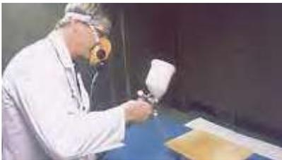
3. Nun können Sie die Fläche z. B. beizen und grundieren und nach dem entsprechenden Zwischenschliff endlackieren.
