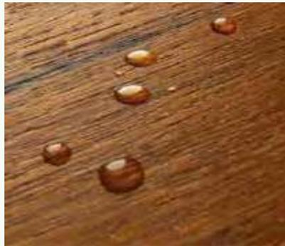
*Wachs bildet eine Schicht auf der Oberfläche und sollte erst nach Behandlung mit einem Öl aufgetragen werden, um eine gute Beständigkeit zu erhalten.*
