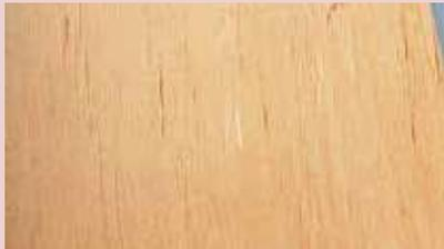
Feinste Kratzer am Beispiel einer mit Öl-wachs behandelten Massivholzplatte
