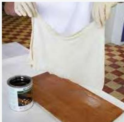
*Breiten Sie stets die Öl-lappen aus und lassen diese ausgebreitet trocknen.*
