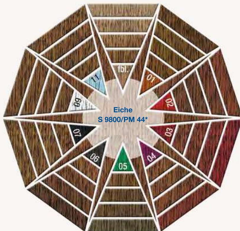
Nuancierungs-Navigator am Beispiel der Antikgrundbeize S 9800 auf Eiche: Der Fertigfarbton (S 9800/PM 44) verändert sich durch Zugabe von Colorkonzentrat CK oder der farblosen Beizbasis entsprechend der Zugabemenge in%.
