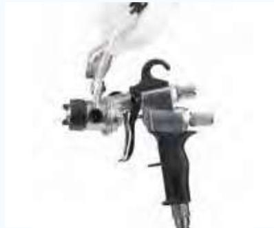
Dünn viskose Materialien werden allein durch die Schwerkraft und durch den Unterdruck an der Düse zerstäubt. Die Abbildung zeigt eine Fließbecherpistole mit der Möglichkeit eines Zusatzluftdrucks von oben für hoch viskose Materialien (Foto: Walter Pilot).
