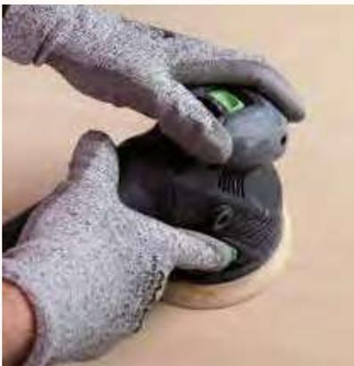
Der Holzschliff mit einem Exzenterschleifer
