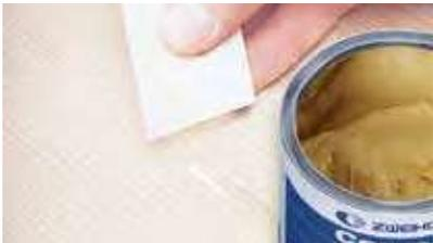
1. Füllen Sie die Fehlstelle mit Correct Holz kitt CHK in dem passenden Holzton. Achten Sie darauf, dass Sie einen kleinen „Berg“ auftragen!
