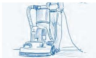
3. Nach einer Trockenzeit von ca. 60–90 Minuten kann dann der versiegelte Boden geschliffen werden. Verwenden Sie hierzu ein Tellerschleifgerät und Schleifscheiben der Körnung 150 sowie anschließend braune Schleifpads (fein). Arbeiten Sie gleichmäßig mit wenig Druck (Gefahr des Durchschleifens!). Der Boden muss überall matt sein. Saugen Sie den Boden und wischen ihn mit einem Staubbündetuch ab. Nun kann Unocryl 1K-Parkettlack UC-P oder Duocryl 2K-Parkettlack DC-P aufgetragen werden.
