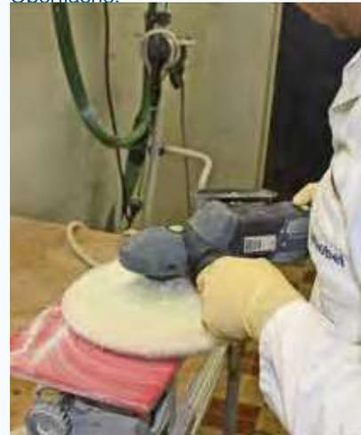
*Hochglanzpolier-Paste HPP wird auf die Fläche gegeben und mittels einer Lammfellscheibe poliert.*
