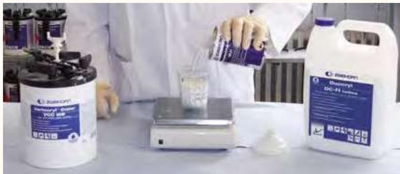
Ansetzen einer farbigen Glaslackierung auf Wasserbasis „All-in-One-Effekt“: Duocryl Klarlack DC mit 1% Variocryl® Metallic VCC/MB und 5% VCC/Weiß unter Zugabe von 20% Glaslackhärter GLH
