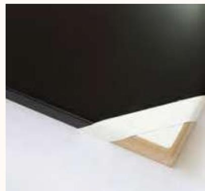
*Dreischichtiger Lackaufbau auf einer folienbeschichteten MDF-Platte: Füller, Buntlack, Klarlack*
