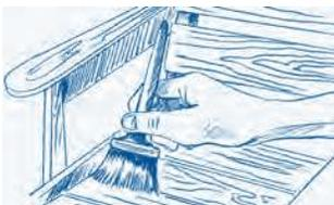
2. Für einen wetterfesten Aufbau wird Naturtrend NHD0 dünn aufgetragen, ohne das Öl anschließend abzunehmen. Hierbei das NHD0 gleichmäßig verteilen und dabei den Pinsel zwischendurch auf einem Tuch abtupfen, um überschüssiges Öl von der Fläche zu nehmen. Lassen Sie die Fläche über Nacht trocknen und wiederholen Sie den Vorgang. Für ein witterungsbeständiges Ergebnis empfehlen wir, drei Aufträge vorzunehmen.
