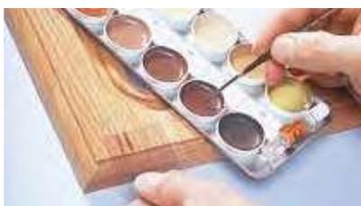
**6.** Farbtonkorrekturen und fehlende Adern können Sie einfach mit dem Correct Tuschkasten CTK herstellen. Stark verdünnt wirken die Farben lasierend, weniger verdünnt deckender.
