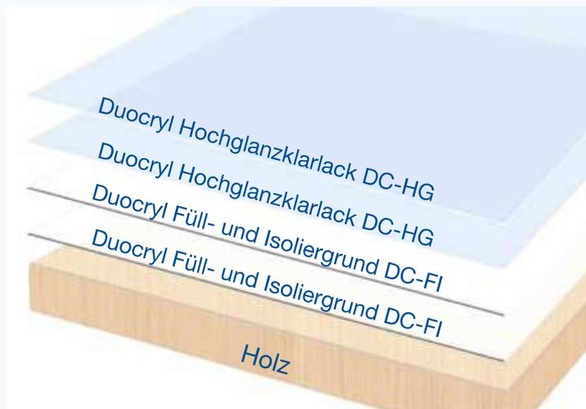
Transparenter Schichtaufbau einer Hochglanzoberfläche mit dem wasserbasierten Duocryl Hochglanzlack DC-HG auf Holz
